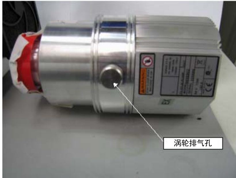
图 B-58 涡轮排气孔
