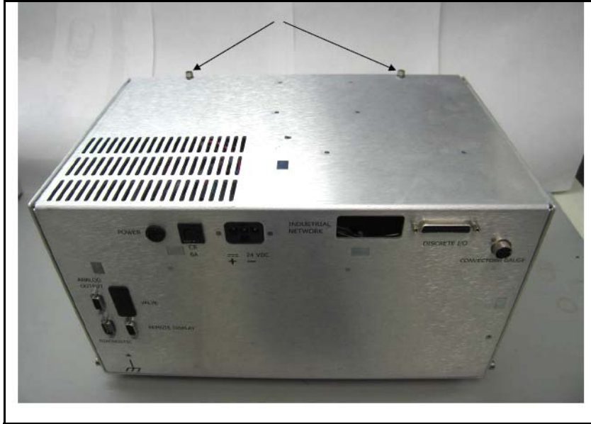
图 B-1 设备顶部的螺丝
