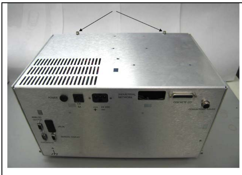
图 B-46 设备顶部的螺丝
