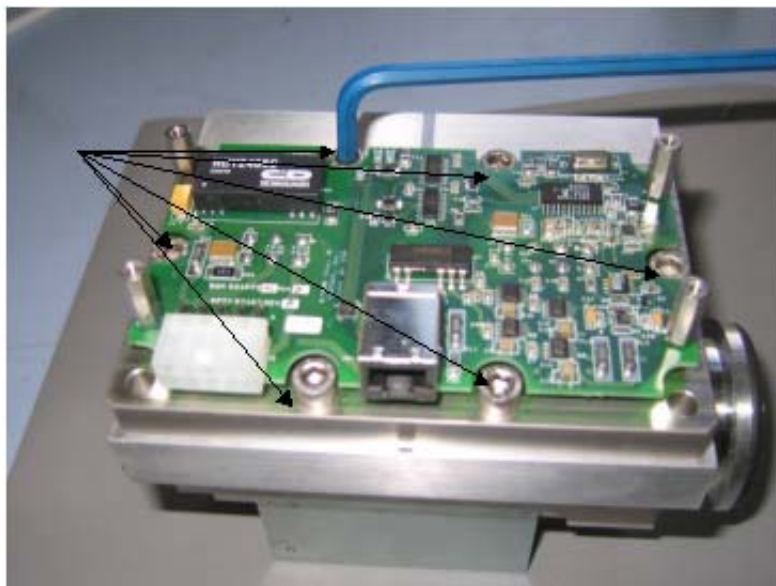
图 B-51 谱仪头部总成螺丝
