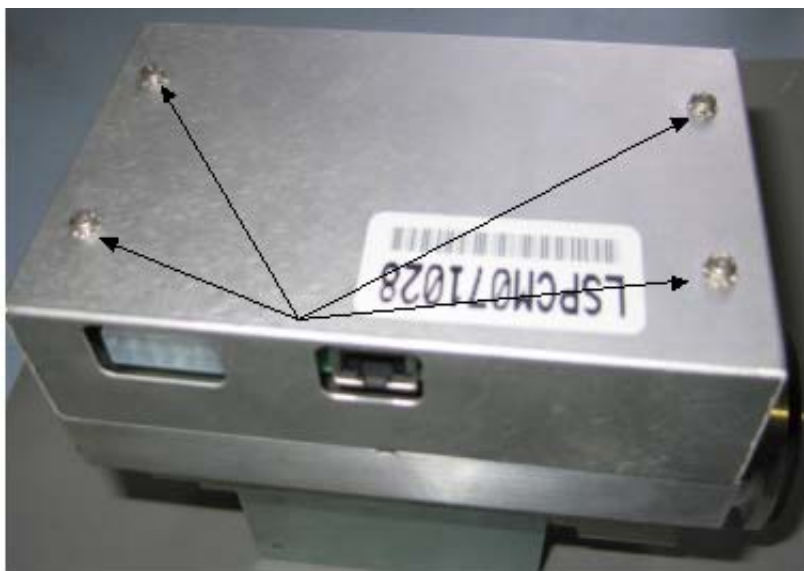
图 B-78 谱仪盖板螺丝
