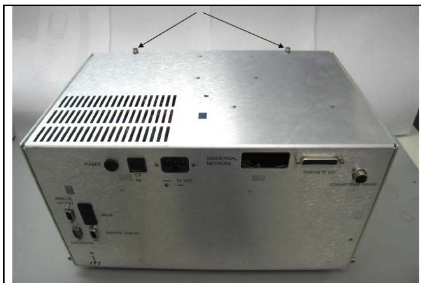
图 B-57 设备顶部的螺丝
