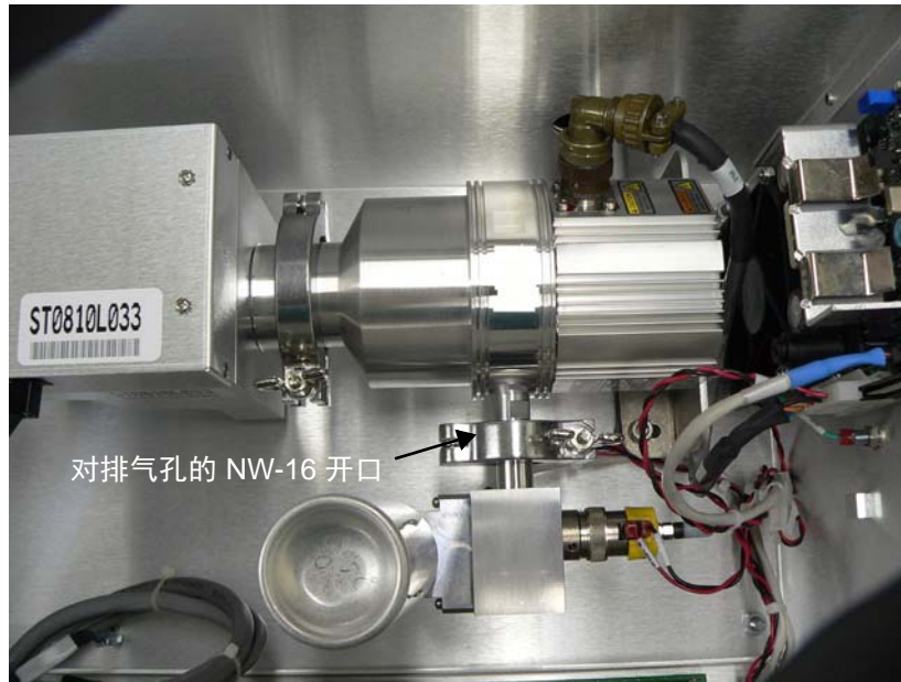
图 B-76 NW-16 排气孔
