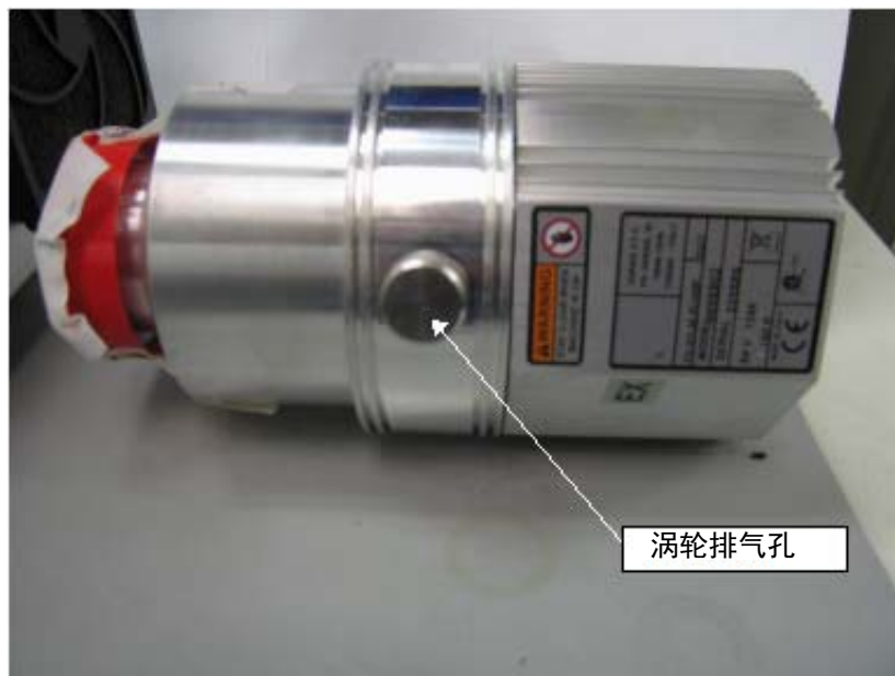
图 B-75 涡轮排气孔
