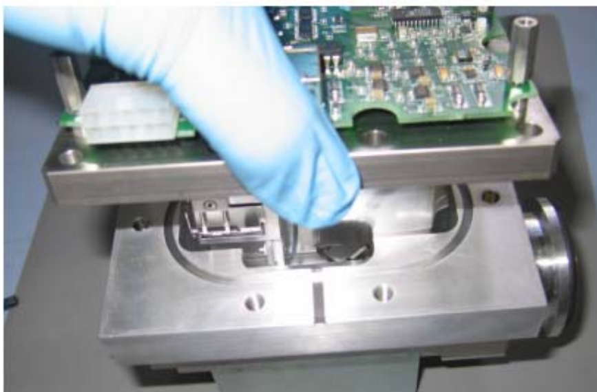
图 B-52 取出谱仪总成
