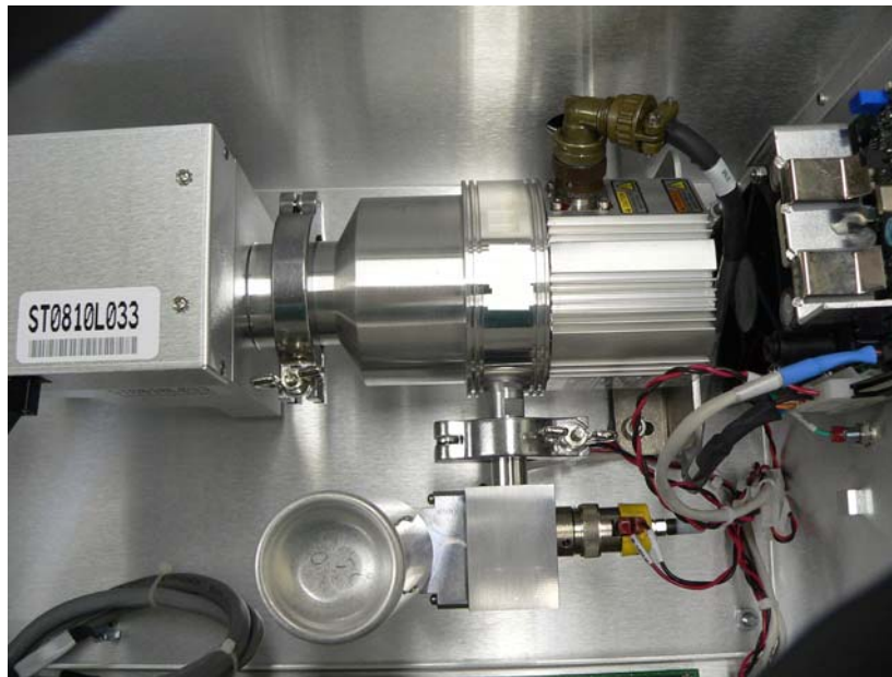
图 B-18 校准泄漏阀到位
