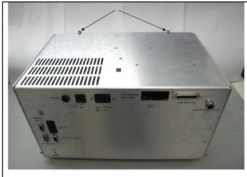
图 B-9 设备顶部的螺丝
