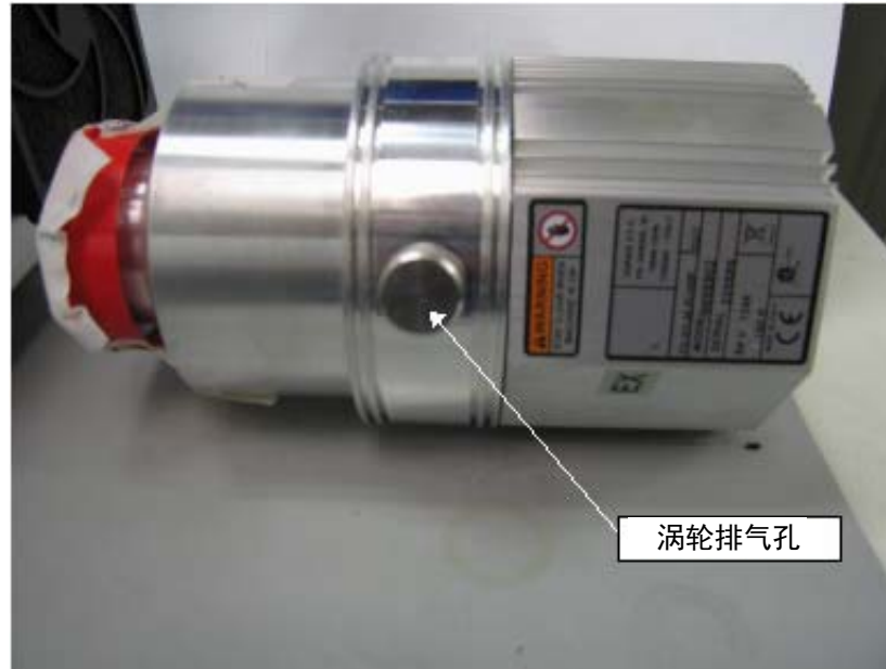
图 B-47 涡轮排气孔
