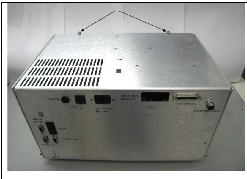
图 B-23 设备顶部的螺丝
