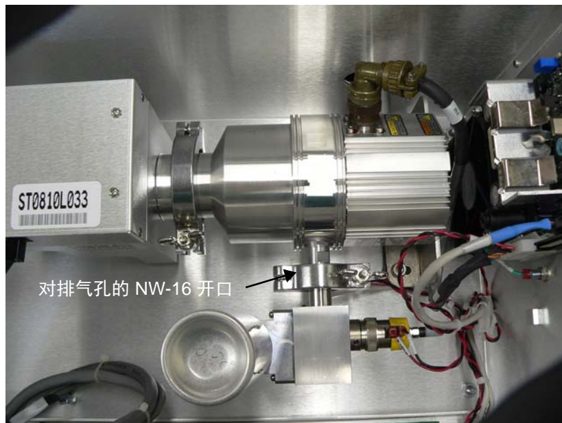
图 B-59 NW-16 排气孔
