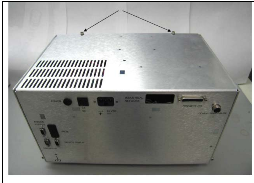
图 B-14 设备顶部的螺丝
