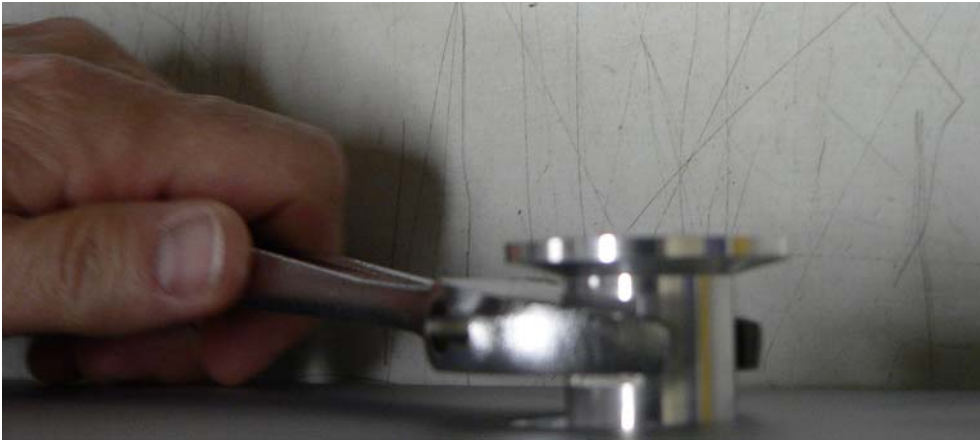
图 B-7 测试端口接头
