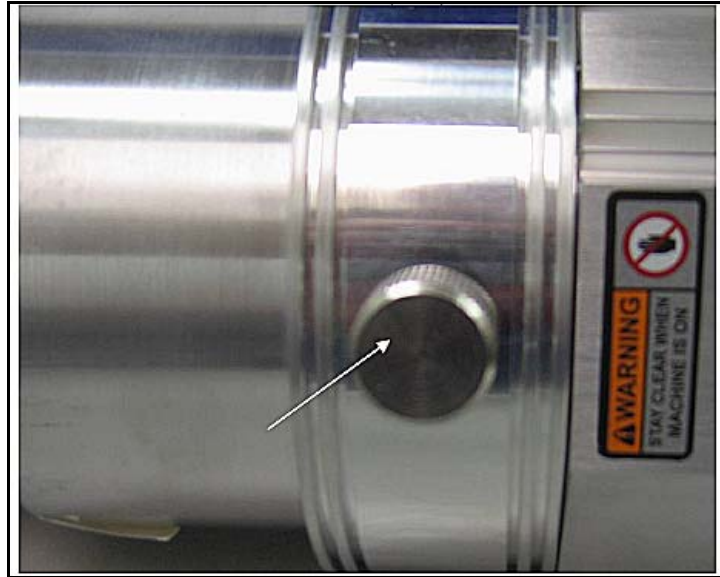
图 B-15 涡轮泵排空孔螺丝
