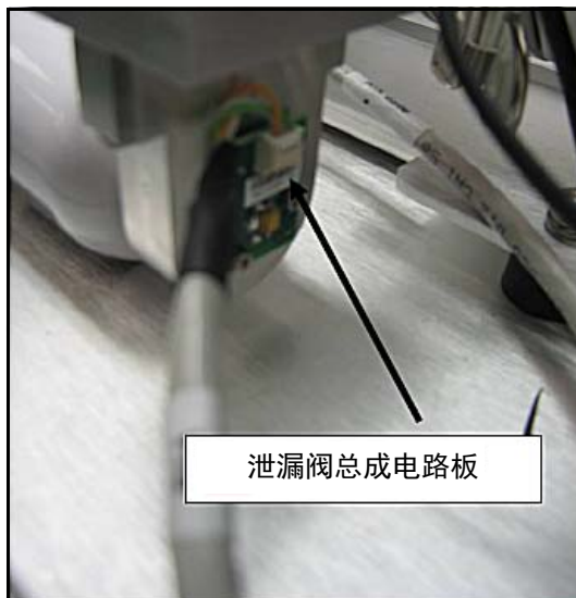
图 B-45 泄漏阀总成电路板的连接
