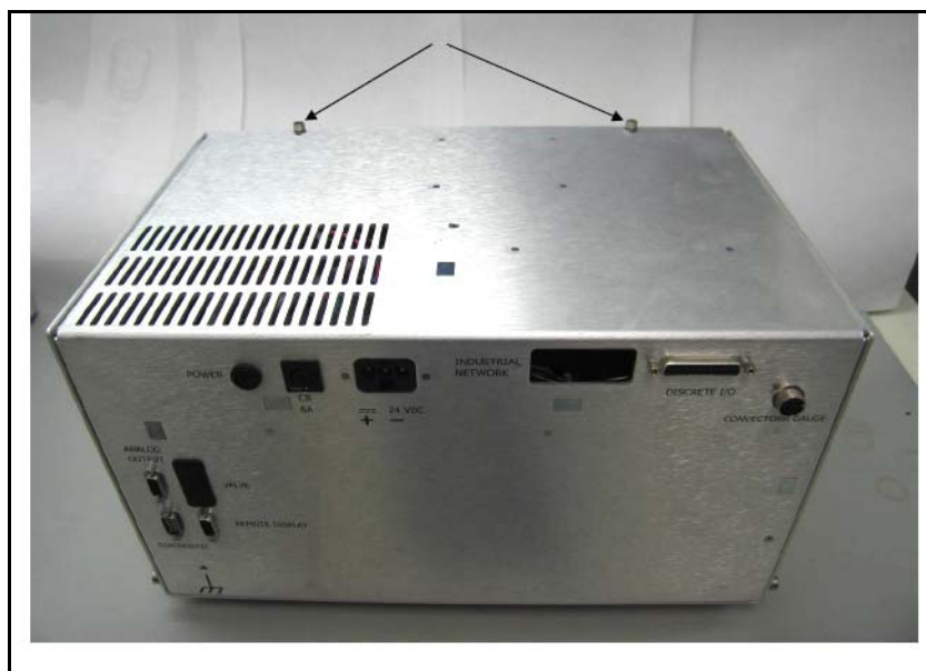
图 B-26 设备顶部的螺丝
