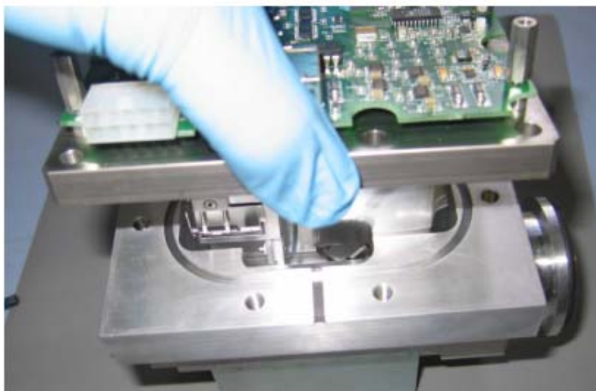
图 B-63 取出谱仪总成
