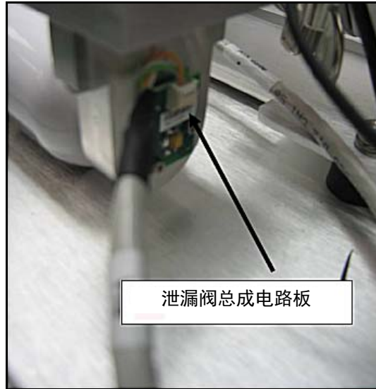
图 B-21 泄漏阀总成电路板的连接
