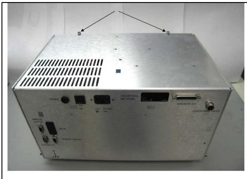
图 B-38 设备顶部的螺丝
