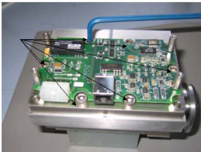
图 B-79 谱仪头部总成螺丝
