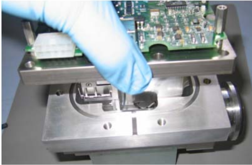
图 B-80 取出谱仪总成
