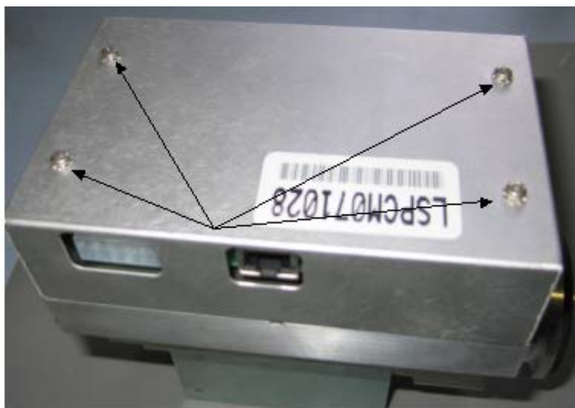
图 B-61 谱仪盖板螺丝
