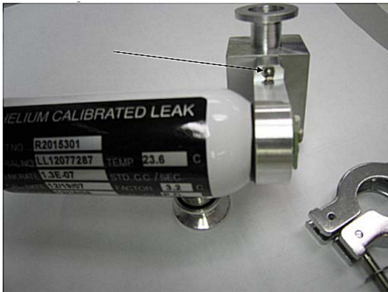
图 B-44 校准泄漏阀的螺丝
