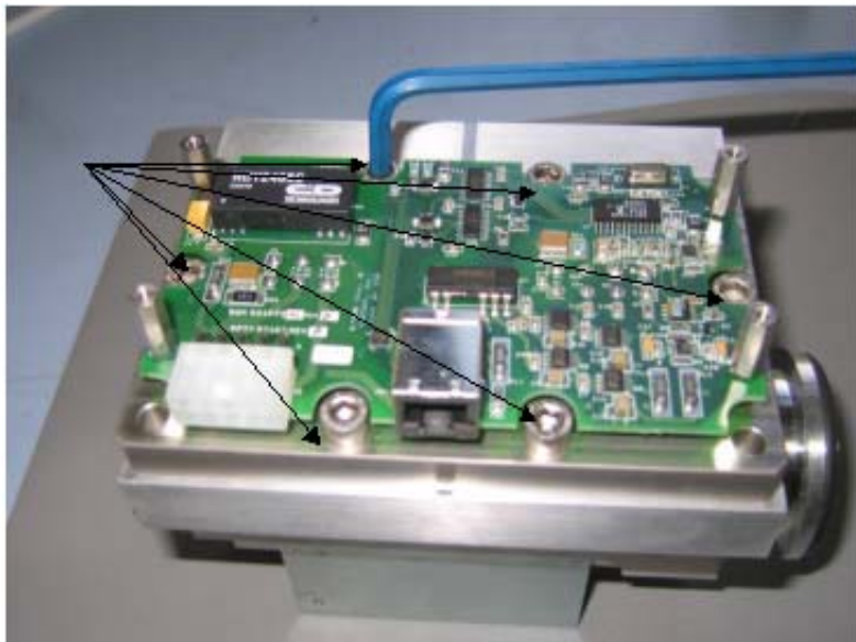
图 B-62 谱仪头部总成螺丝
