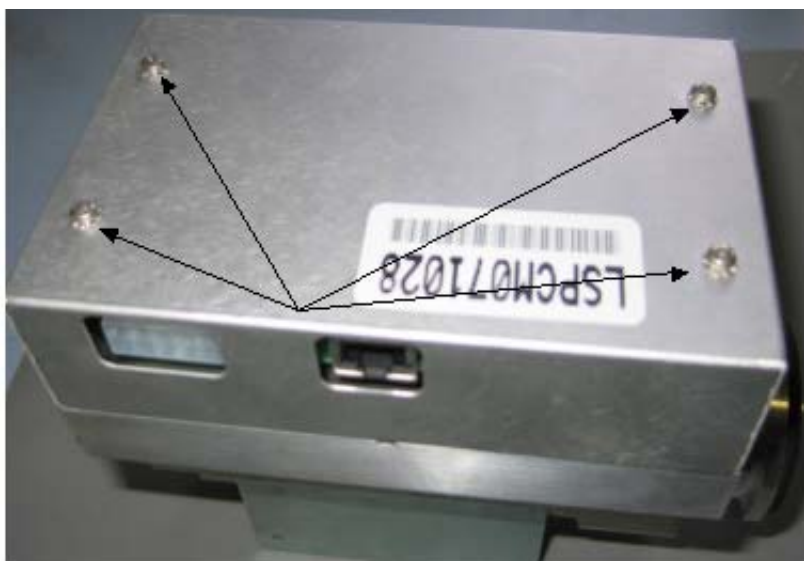
图 B-50 谱仪盖板螺丝
