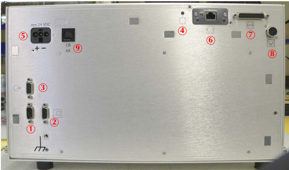
图 1-6 VS C-15 基站设备的后置面板
