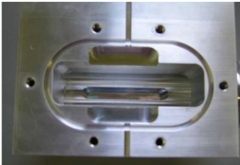
图 B-65 谱仪的机身内部
