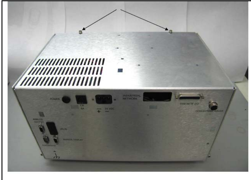
图 B-74 设备顶部的螺丝
