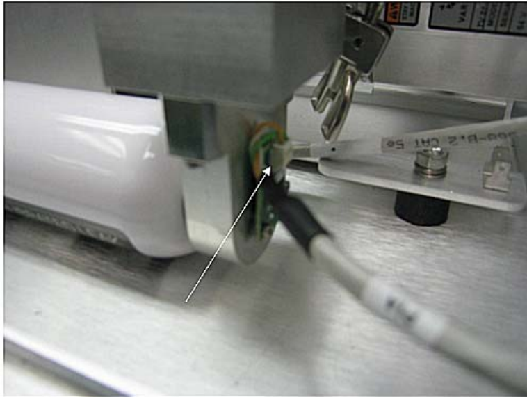
图 B-42 校准泄漏连接电缆
