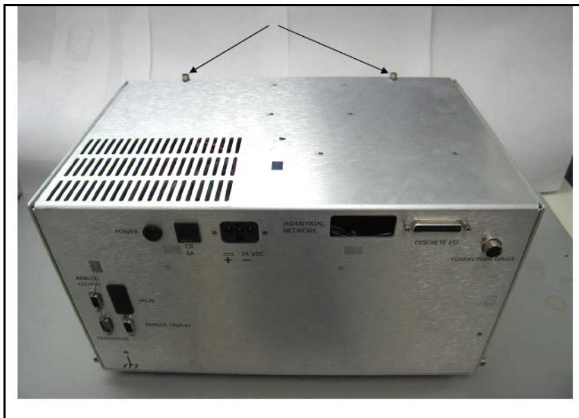
图 B-31 设备顶部的螺丝
